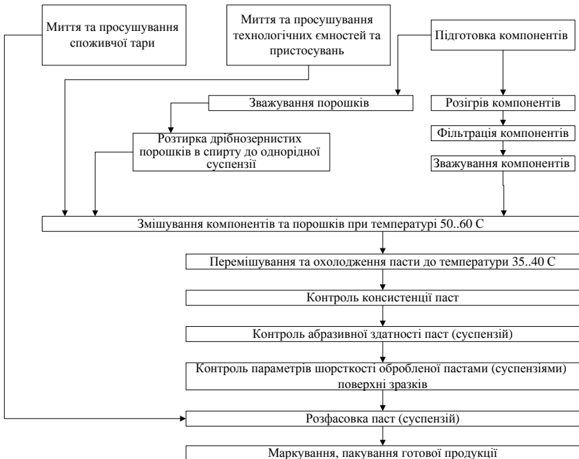
Рисунок 7.22 – Технологічна схема виготовлення паст і суспензій з НТМ
