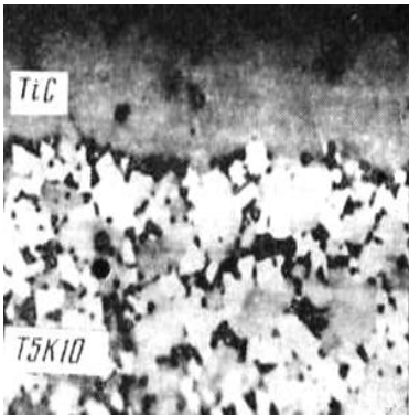
Рисунок 6.6 – Мікроструктура твердого сплаву T5K10 з покриттям TiC ГТ
