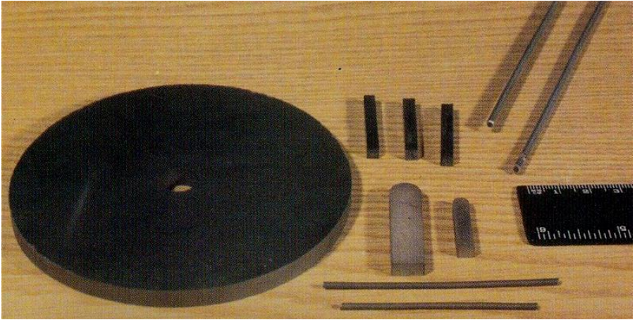
Слайд 17 – Стрижневі та дискові електроди для електроіскрового легування, отримані СВС
