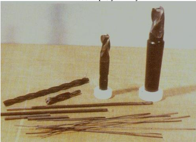
Слайд 16 – Довгомірні електроди для зварювання, наплавлення і електроіскрового легування, отримані СВС
