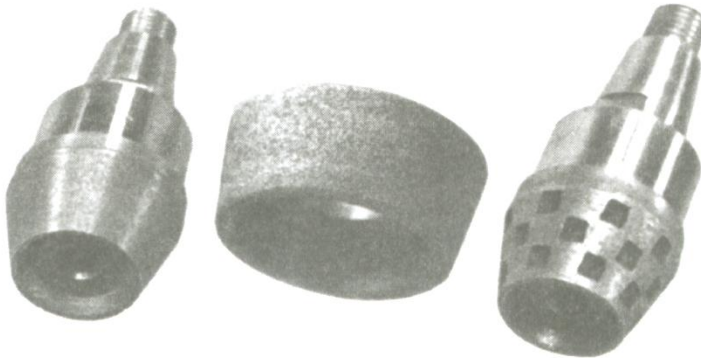
Слайд 3 – Конічні круги із НТМ на гальванічній та твердосплавній зв'язках
