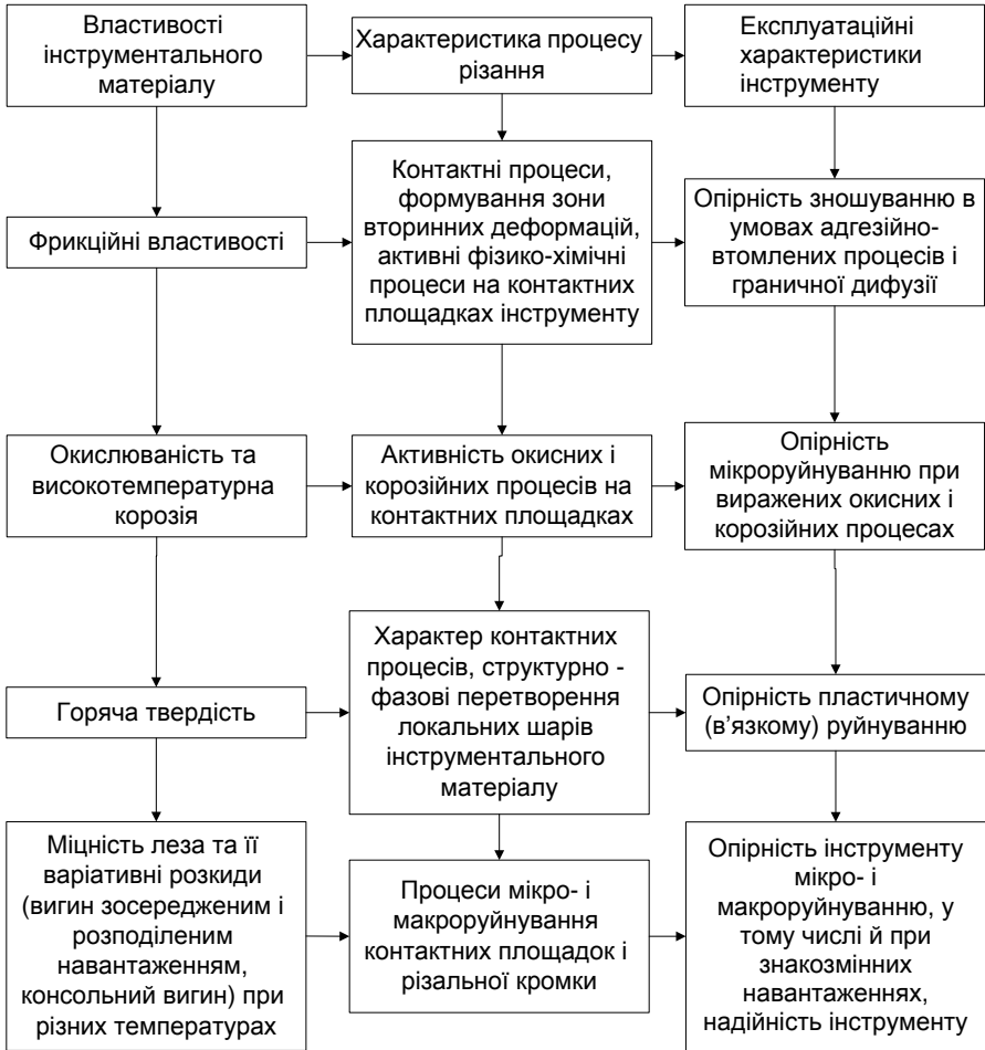
Рисунок 6.14 – Взаємозв'язок між властивостями інструментального матеріалу після нанесення покриття, характеристиками процесу різання та експлуатаційними характеристиками інструменту
