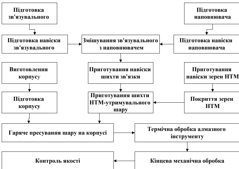
Рисуюнок 7.16 – Технологічна схема виготовлення кругів з НТМ на жорсткій органічній зв'язці
