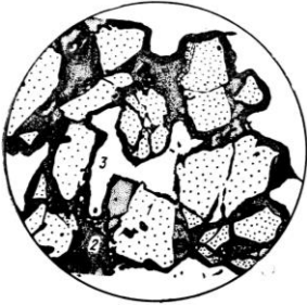
Рисунок 7.1 – Мікрофотографія шліфа шліфувального круга на рівні 50 мкм: 1 – абразивне зерно; 2 – зв'язка; 3 – пори
